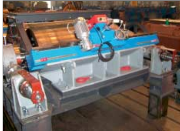
»5 Pilatus roller-turning machine WDM/GLR on FAM roller mill (FAM Magdeburg/Germany) »4 Pilatus-Walzendrehmaschine WDM/GLR auf FAM-Walzwerk (FAM Magdeburg/Deutschland)
