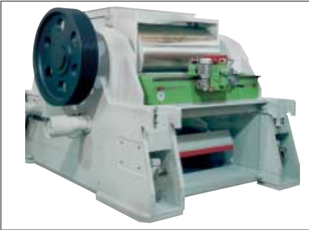
»4 Pilatus roller-turning machine WDM/GLH on Händle fine roller mill "Alpha" (Händle Mühlacker/Germany) »4 Pilatus-Walzendrehmaschine WDM/GLH auf Händle-Feinwalzwerk „Alpha“ (Händle Mühlacker/Deutschland)
